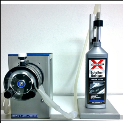
ECO2500 mit angebautem Düsen/Flaschenhalter ECO2500 with attached nozzle/bottle holder
